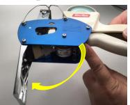
④ 本体を逆さに持ち、ラベルが出てくるまでグリップを数回握り、ラベルを出します。 出てきたラベルを折り返し、ラベルの穴を本体の【スプロケットの針】にはめ込みます。
