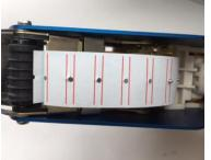
⑤【カッター】で押さえ、【アンダーカバー】を閉じて、完了。 ※ はじめの3~4枚は印字がズレたりしますので、安定するまで繰り出してください。
