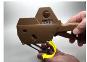
②【ワンタッチレバー】を引き上げ、ラベルを挿入します。
