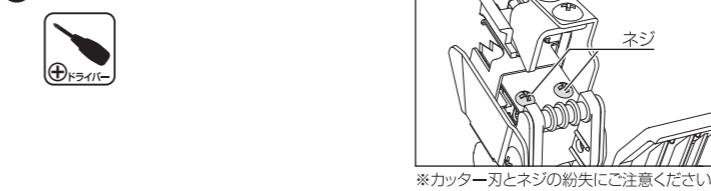
④ 新しいカッター刃をネジ穴が合うように置き、上からネジをとめます。
