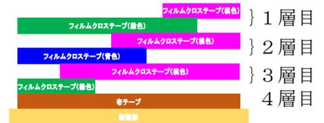
図-1 積層養生テープ 断面図
