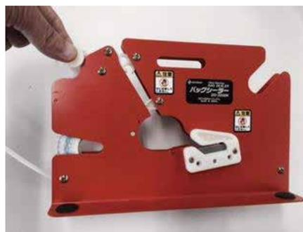
② 印刷面が内側になるように開封紙をセットします。
