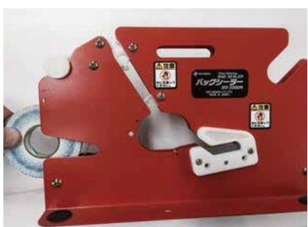
⑤ ガイドレバーを持ち上げながら、ネック挿入口に開封紙を挿入します。
